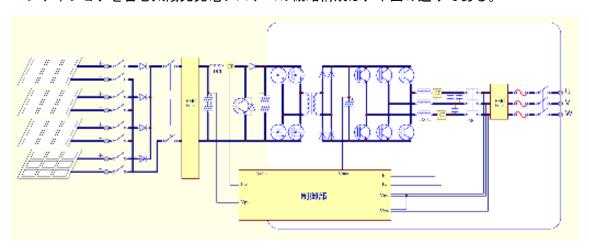
本パワーコンディショナは内部に絶縁変圧器を有し、直流側(太陽電池側)と商用電力系統側が絶縁されている。また、系統連系規程 JEAC-9701-2012 に準拠した系統連系保護機能を内蔵する。
